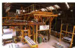
北海道で産出される火山礫を主原料としたコンクリートブロックは全て自社工場にて製造。強度にも厳しい自社基準を設け、高品質なブロックを造っている。
