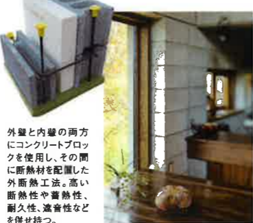
コンクリートブロックの空洞部分に鉄筋を挿入し、そこにモルタルなどを流し込むことでより堅牢な構造に仕上げていく。
